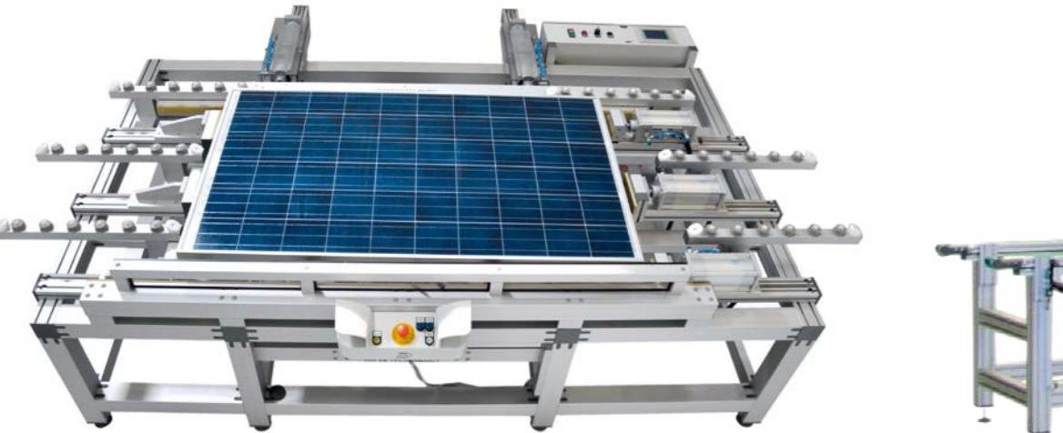
Leistungsmessung (Flasher) von Solarmodulen
