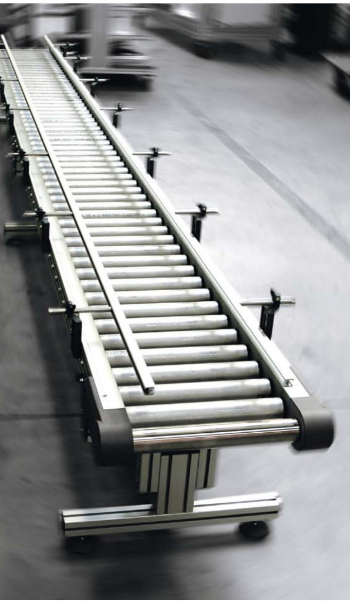
Angetriebene Rollenbahn mit Seitenführung
