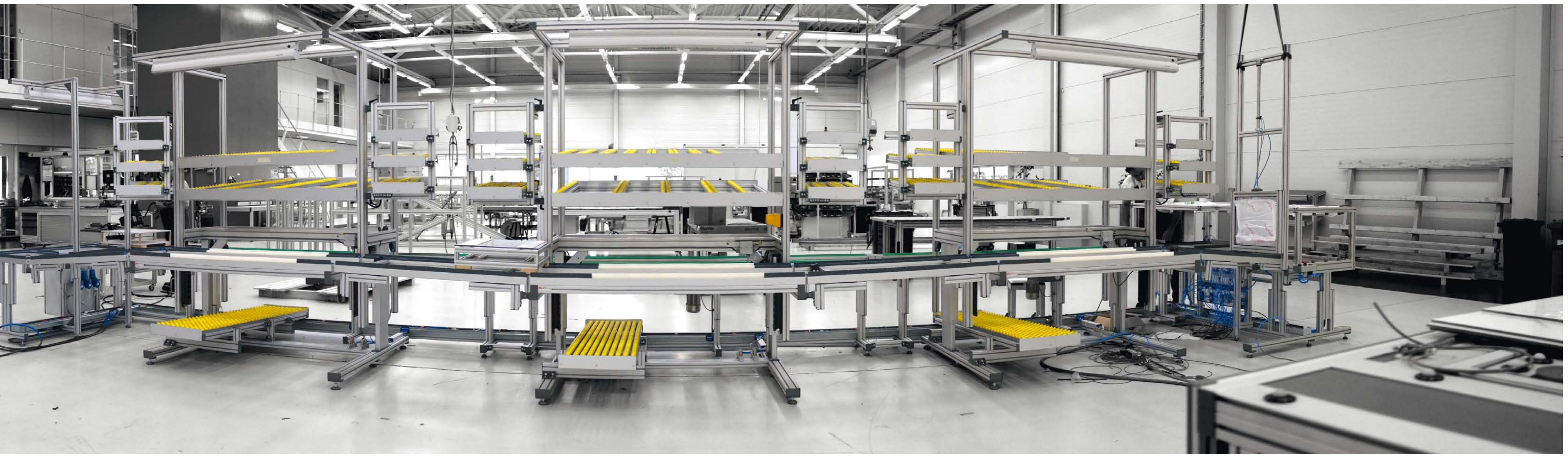
Montagelinie mit Materialbereitstellung und Werkstückträgersystem | Assembly line with material provision and tooling system | Ligne d'assemblage
