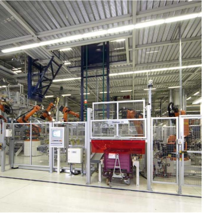
*Schutzeinrichtungen mit Schleuse | Safety fences with material lock | Dispositif de protection avec sas*
