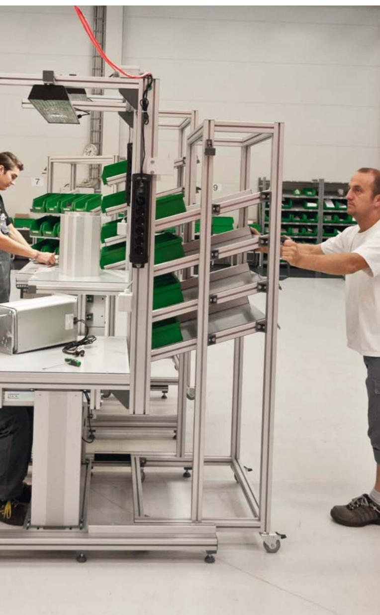
Höhenverstellbare Montage-Arbeitsplatzsysteme mit mobiler Materialbereitstellung
