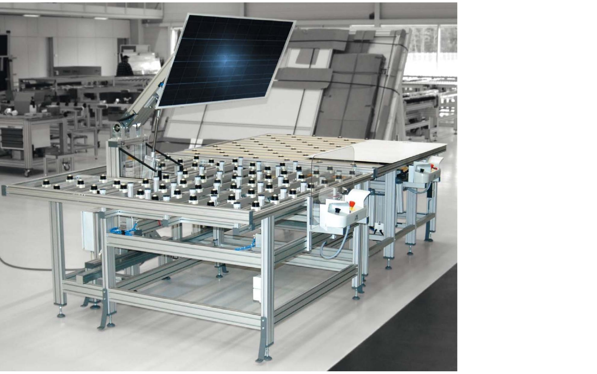
Kugelrollentisch mit Vakumsaugern und Greifsystem | Balls table with vacuum suction and gripping system | Table à billes avec unité de préhension équipée de ventouses
