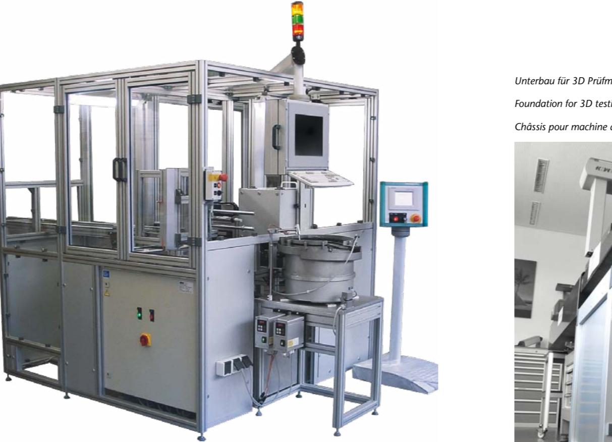
Maß- und Oberflächenprüfung von Hochdruckverschraubungen
